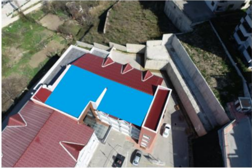
Şekil 6. 19 Panel Çatı Yerleşim Planı
