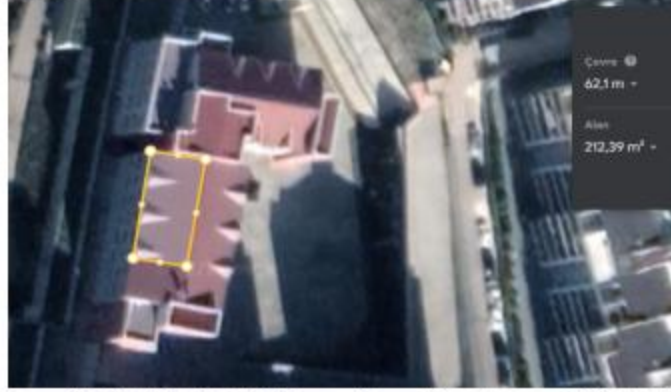
Şekil 8.3.2.1 Yağmur Suyu Toplanacak Çatı Alanı
